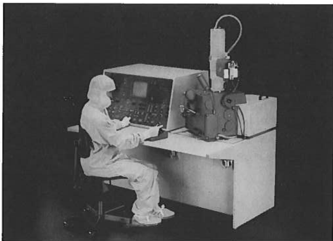
De scanning-elektronenmicroscop SEM 545 van Philips in gebruik in een stofarme ruimte.
